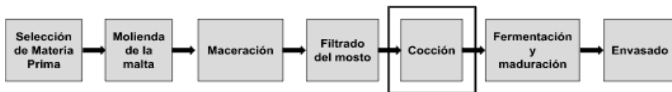
Figura 11. Diagrama de bloques. Registro de datos: Cocción.
